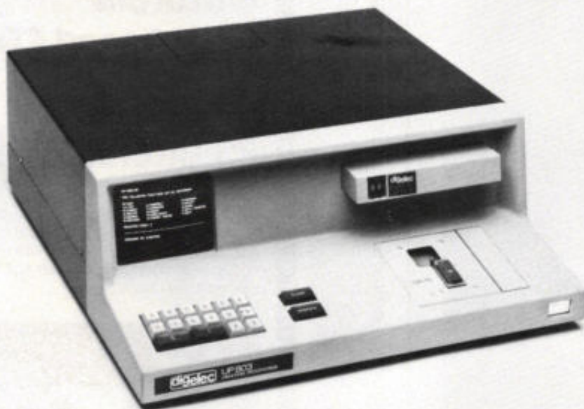
Afb.5. In dit PROM-programmeerapparaat past een module die het mogelijk maakt PAL's te programmeren. Zonder hulp van andere rekenapparaten kan men hiermee alle stappen verrichten die voor het ontwerpen van een schakeling nodig zijn (foto: Digilec/Koning en Hartman).
